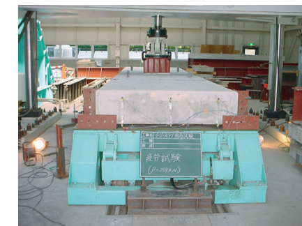
繰り返し荷重載荷(200万回)試験状況
