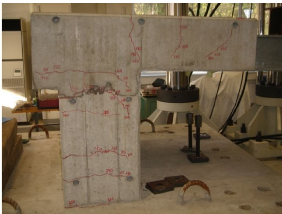
写真-4.3 ひびわれ状況 (側面より)
