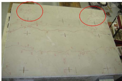
写真-4.1 ひびわれ状況 (上面より)
