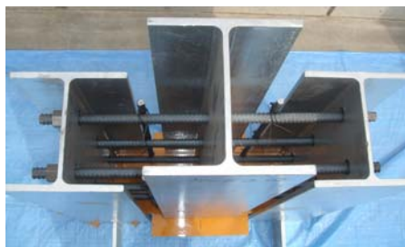
写真-2.1 コンクリート打設前の熔融亜鉛メッキ処理タイプの供試体（上面より撮影）
