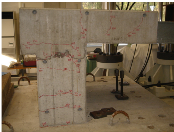
写真-4.3 ひびわれ状況（側面より），補強桁有，メッキ処理（case2①）
